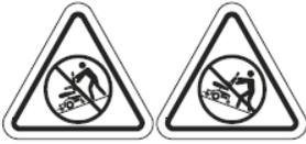
**WARNUNG!** Benutzen Sie Ihren Elektrorollstuhl nicht, während die Antriebsmotoren ausgekuppelt sind! Kuppeln Sie die Antriebsmotoren nicht aus, wenn der Elektrorollstuhl sich auf einer Schräge befindet, da er anfangen könnte von alleine zu rollen. Benutzen Sie den Freilaufmodus nur auf ebenen Flächen.
