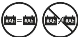
**VERBOTEN!** Kontaktieren Sie immer zwei Batterien von exakt der gleichen Bauart, Chemie und Amperestundenkapazität (Ah). Schlagen Sie die Spezifikationstabelle in diesem Handbuch, das mit dem Ladegerät geliefert wurde nach, um empfohlene Typen und Kapazitäten zu finden.
